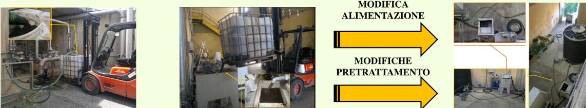
Per il progetto sono stati progettati e realizzati appositamente **due impianti pilota di digestione anaerobica da 5m<sup>3</sup>**.
