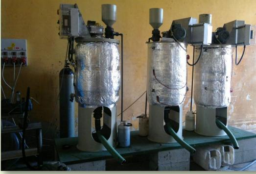
Sono stati progettati e realizzati 3 piloti da 150L per la generazione ed espansione degli inoculi e le prove preliminari di co-digestione dei fanghi con i rifiuti conciari
