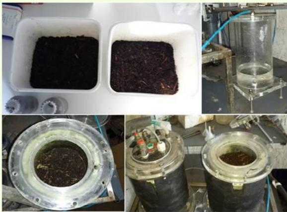
Le prove di compostaggio sono state condotte perlopiù a scala di laboratorio sfruttando dei reattori appositamente realizzati e attrezzati per gli scopi di progetto.
